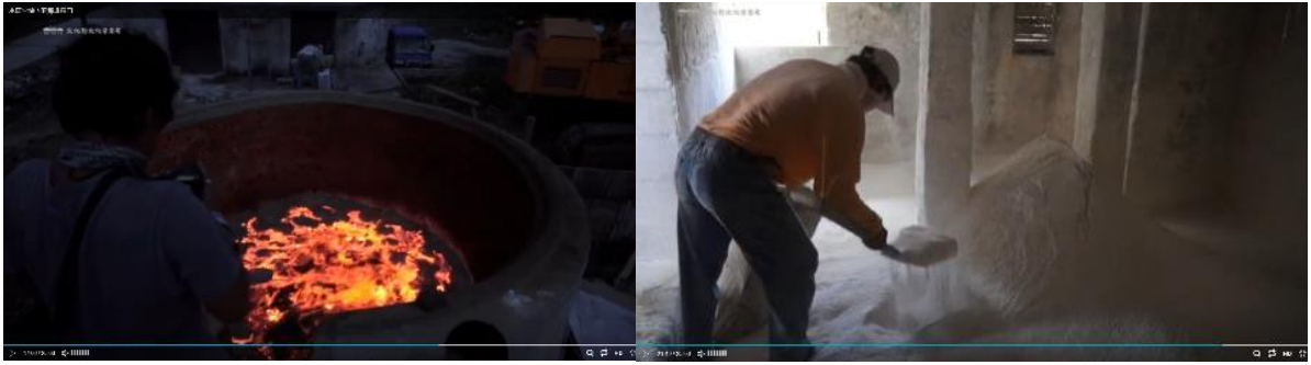
圖 4.6：台灣文化部重現燒製石灰工藝的記錄影像 42
